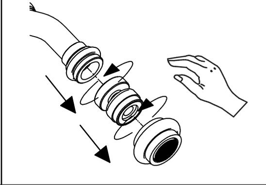
**SOSTITUZIONE VITONE / VALVE REPLACEMENT**
